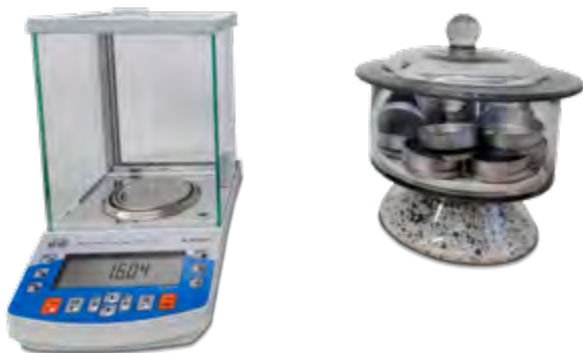
Ryc. 2. Waga analityczna i eksykator z naczynkami do oznaczenia wilgotności (fot. A. Salamon)
