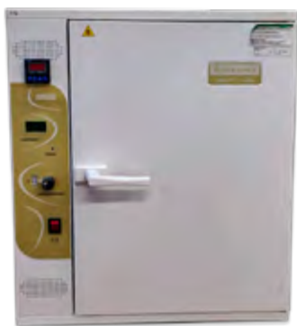
Ryc. 1. Suszarka z grawitacyjnym obiegiem powietrza do oznaczenia wilgotności (fot. A. Salamon)
