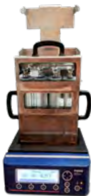
Ryc. 5. Piec do mineralizacji próbek przy oznaczaniu zawartości białka (fot. A. Salamon)
