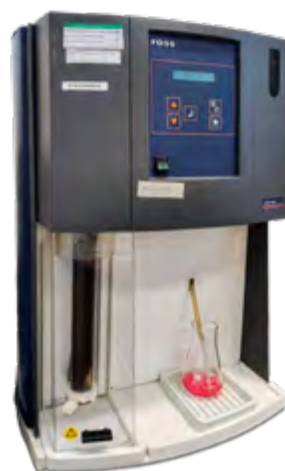
Ryc. 6. Stanowisko do destylacji azotu i miareczkowania przy oznaczaniu zawartości białka (fot. A. Salamon)
